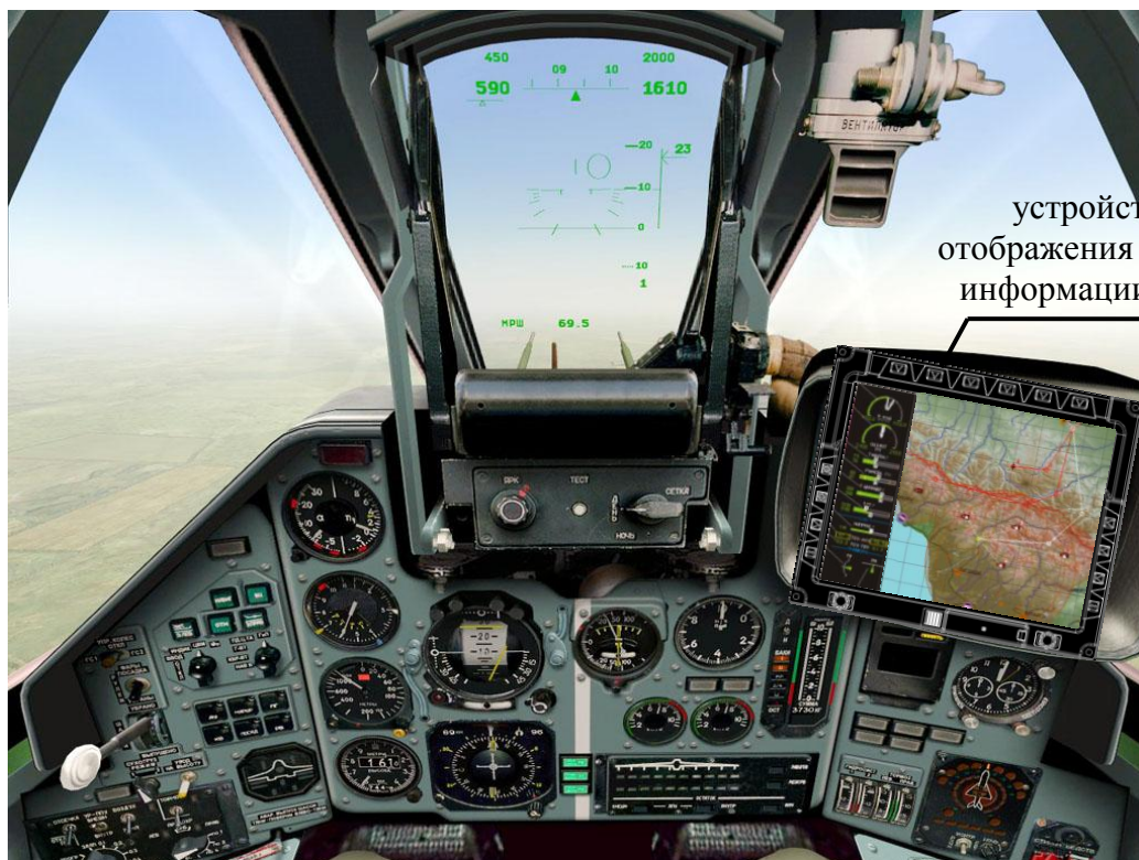
Рис. 3.3. Примеры размещения устройств отображения и ввода информации ВПУ а) при наличии штатных МФЦМ (Су-34, МиГ-35 и др.); б) при необходимости дооснащения МФЦИ (Су-24, Су-25 и др.)
