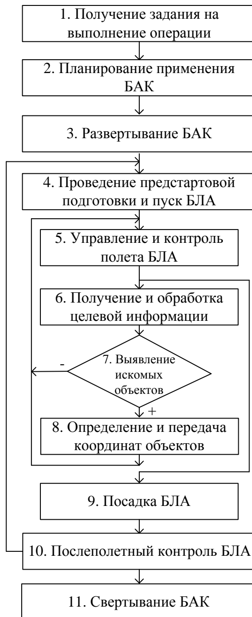
Рис. 1.7. Укрупненный алгоритм функционирования ИнБАК
