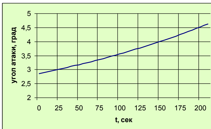
Рис. П1.12. Изменение угла атаки БЛА при наборе высоты по линейной траектории
