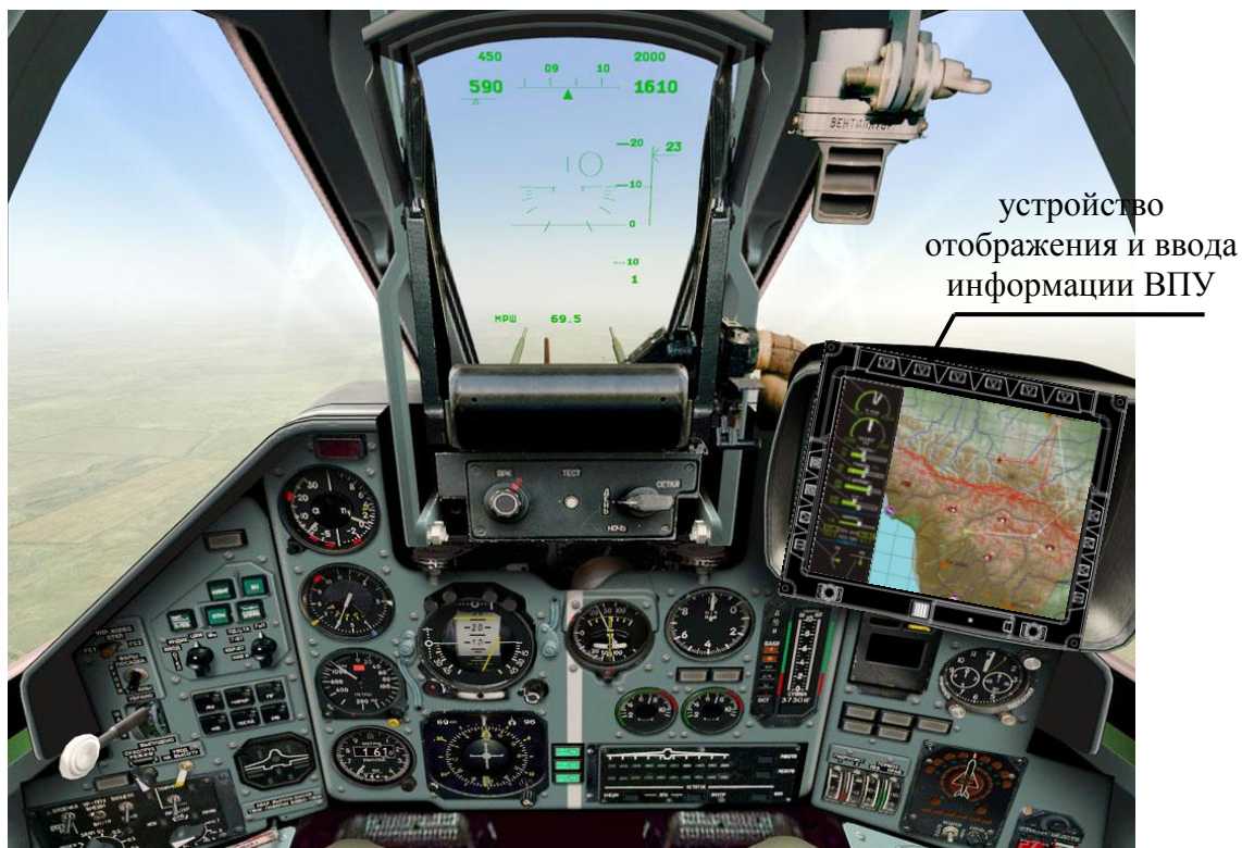
Рис. 3.3. Примеры размещения устройств отображения и ввода информации ВПУ а) при наличии штатных МФЦМ (Су-34, МиГ-35 и др.); б) при необходимости дооснащения МФЦИ (Су-24, Су-25 и др.)
